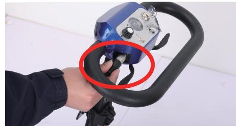
En el lado izquierdo de la parte delantera del scooter, hay un puerto de carga. Utilice el cargador estándar para cargar el scooter.
