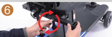
Ajustez le siège de montage de l'accoudoir à la position appropriée, puis serrez la vis de la poignée longue. (Répétez cette opération de l'autre côté)
