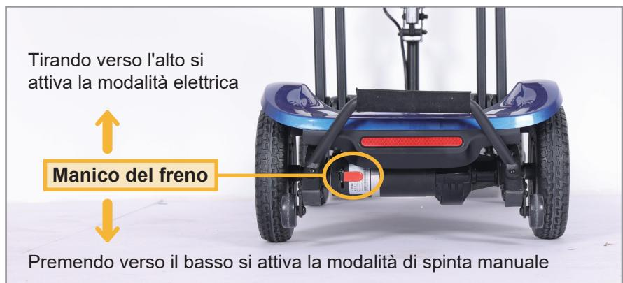
La maniglia del freno si trova nella parte posteriore sinistra dello scooter. Quando la maniglia del freno è in posizione abbassata (modalità manuale/push), lo scooter è in uno stato senza freni e non può essere alimentato dalla batteria, ma solo spinta.
