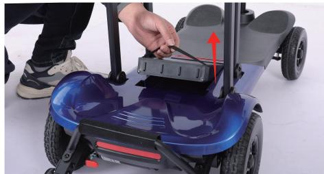
Afferrare la maniglia della batteria e sollevare la batteria verso l'alto per rimuoverla.
