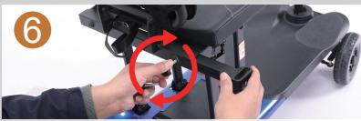
Ajuste el asiento de montaje del reposabrazos a la posición adecuada y, a continuación, apriete el tornillo de la manija larga. (Repita esta operación en el otro lado)
