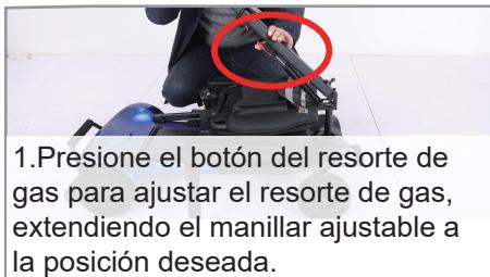
1.Presione el botón del resorte de gas para ajustar el resorte de gas, extendiendo el manillar ajustable a la posición deseada.
