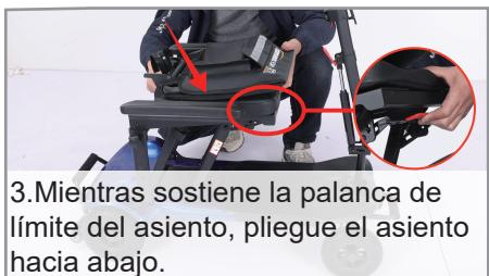
3.Mientras sostiene la palanca de límite del asiento, pliegue el asiento hacia abajo.
