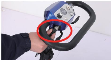
Sul lato sinistro della parte anteriore dello scooter, c'è una porta di ricarica. Utilizzare il caricabatterie standard per caricare lo scooter.
