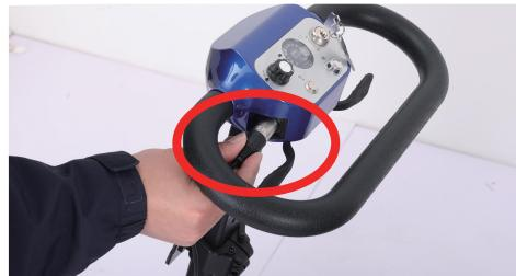
Auf der linken Seite der Vorderseite des Rollers befindet sich ein Ladeanschluss. Verwenden Sie das Standard-Ladegerät, um den Roller aufzuladen.
