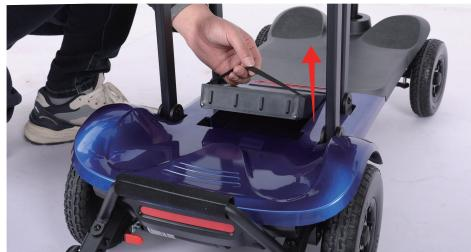
Fassen Sie den Batteriegriff und heben Sie den Akku nach oben, um ihn zu entfernen.
