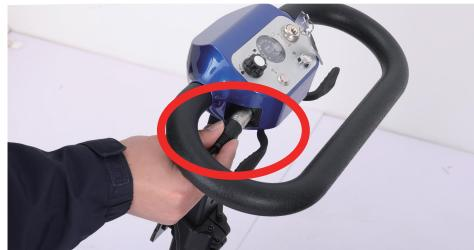
Sur le côté gauche de l'avant du scooter, il y a un port de charge. Utilisez le chargeur standard pour charger le scooter.
