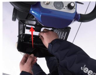
3.Coloque el fondo de la canasta plano hacia abajo.
